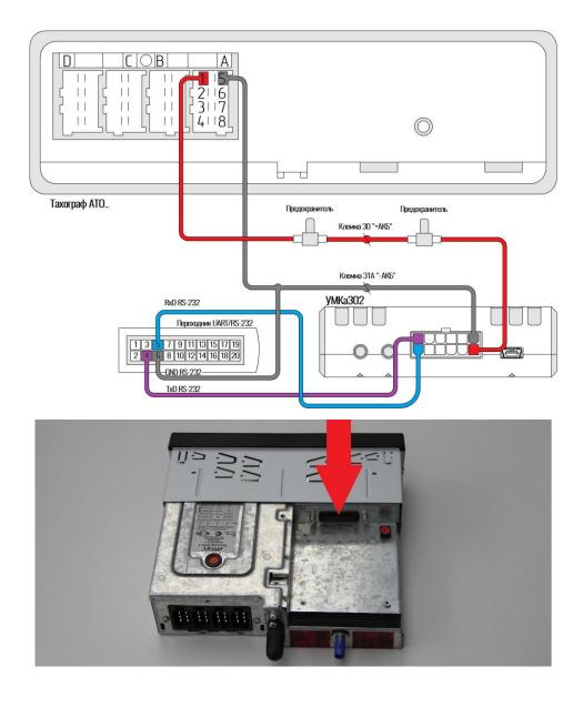
$RS-232\ line\ TxD\ of\ the\ tracker\ UMKa-302\ on\ RxD\ contact\ of\ UART/RS-232\ adapter.$
